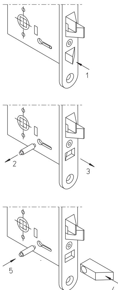
FÖRREGLINGSKOLVENS LÄNGD ÄR 22 mm, ANVÄND LÄNGRE FÖRREGLINGSKOLV 33mm, OM DÖRRSPRINGAN > 6 mm. KONTROLLERA AVSTÄNDET TILL DÖRRMAGNETEN.
