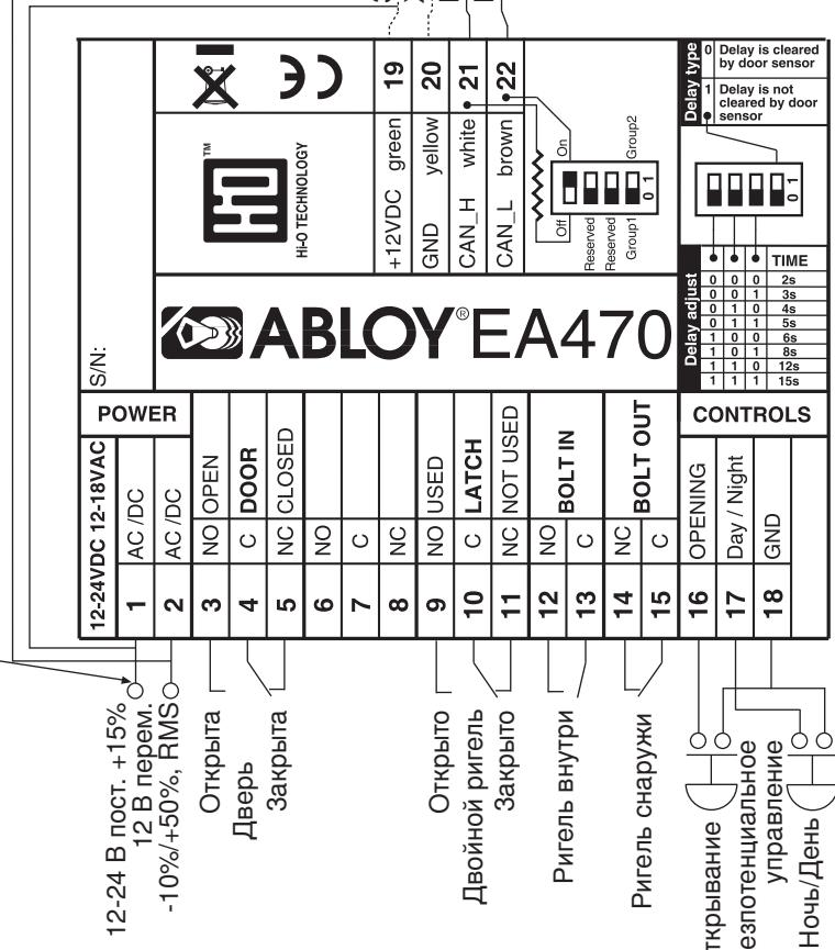
Зелёный и жёлтый провода от кабеля EA216 можно подключить к клеммам 1 & 2 или 19 & 20.
